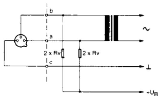
3. Si les entrées de l'amplificateur sont mises à la terre ou si l'on ne dispose pas de transformateurs d'entrée il sera nécessaire d'interposer sur les lignes b.f. soit des condensateurs soit des transformateurs supplémentaires, afin d'éviter que des courants de fuite ne viennent perturber l'étage d'entrée.
