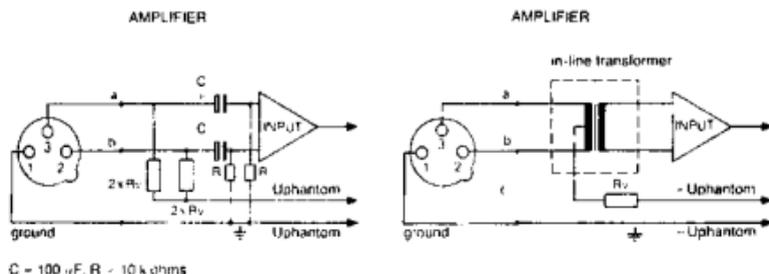
Este circuito puede incorporarse posteriormente con toda facilidad y a un precio bastante módico en casi todos los circuitos existentes y evita la adquisición de alimentadores adicionales.
