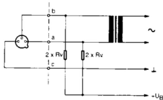
3. Sind die Verstärkereingänge geerdet oder keine Eingangsübertrager vorhanden, müssen entweder Kondensatoren oder zusätzliche Transformatoren in die NF-Leitungen eingefügt werden, um eine Beeinträchtigung der Eingangsstufe durch Leckströme zu verhindern.
