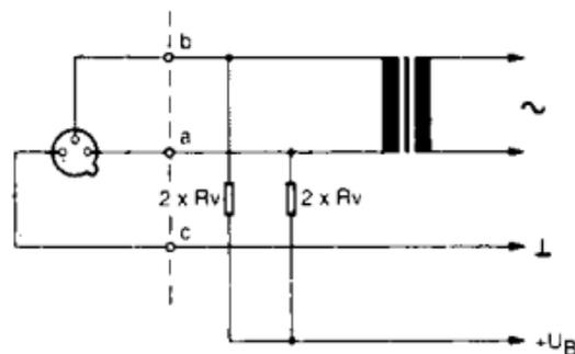
3. Se gli ingressi dell'amplificatore sono collegati a terra o se non esiste una trasformazione d'ingresso, bisogna inserire condensatori o trasformatori aggiuntivi nelle linee a bassa frequenza, per impedire che lo stadio d'ingresso venga perturbato da correnti di dispersione.
