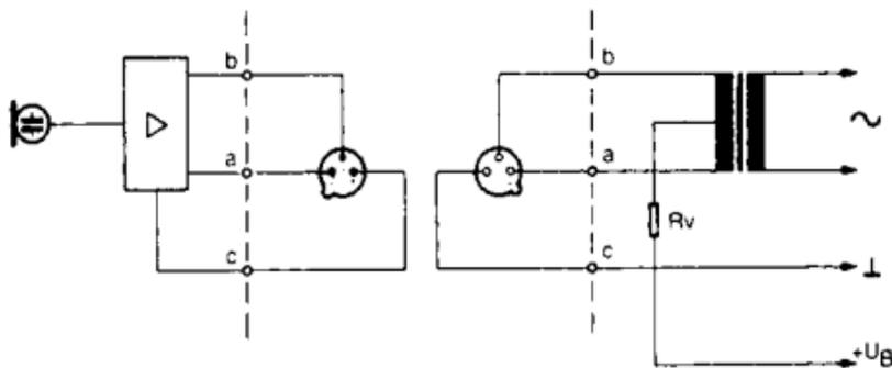
2. Collegamento con trasformatore d'ingresso **senza** presa mediana (senza terra):
